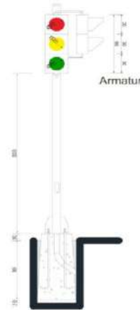
Gambar 2.13 Spesifikasi Teknis APILL Tiang Lurus
