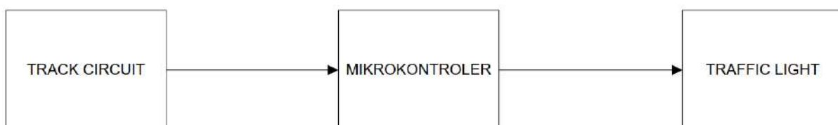
Gambar 4.14 Diagram Blok Simulasi Sistem Traffic light Terintegrasi Perlintasan Kereta Api.
